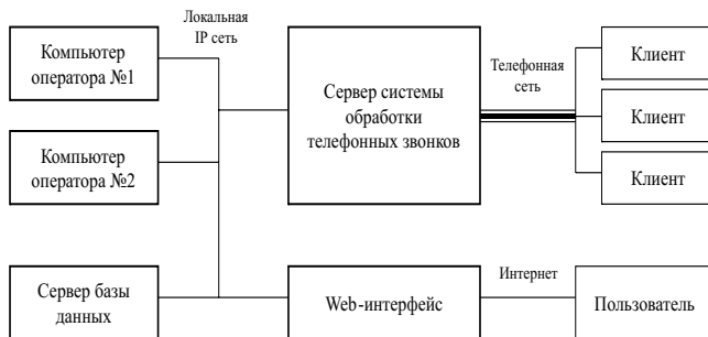
Рис. 1: Общая схема системы компьютерной телефонии
